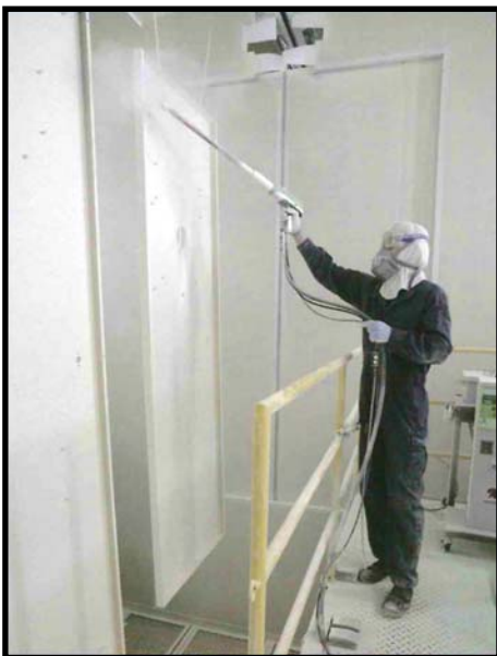
▲粉体塗装補正ブース ロング“マズル”を使用し、 大型ワークの補正を容易にして いる
